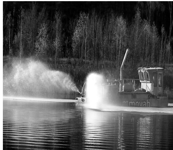
Abb. 2: Sanierungsschiff auf dem RL 122 Tröbitz im Verteilbetrieb
