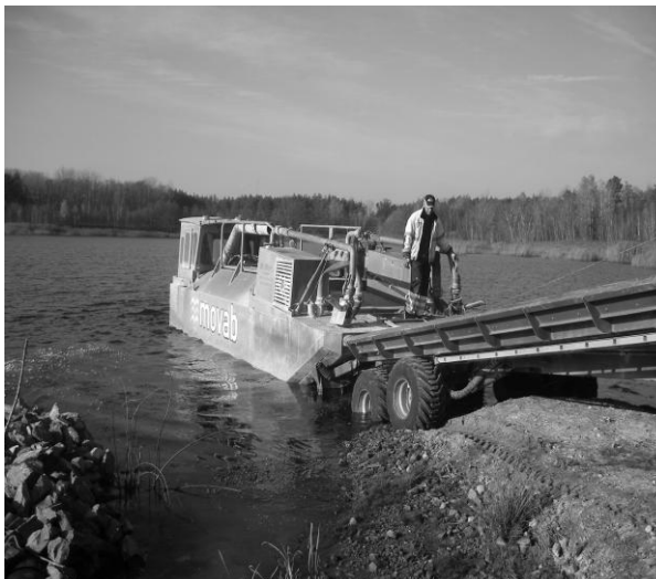
Abb. 1: Trailer mit Sanierungsschiff beim Wässern
